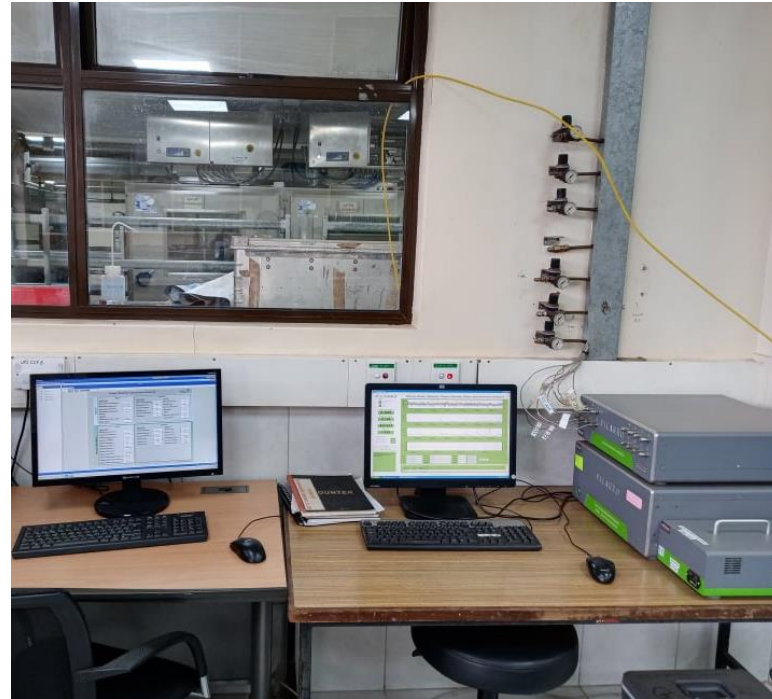
3 Picarro Laser Analyzers ( N_2O , CH_4 , CO_2 , H_2O , NH_3 )
